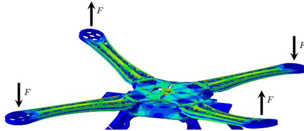
FEM-Simulation der lokalen Von-Mises-Spannungen eines Drohnengehäuses. [
